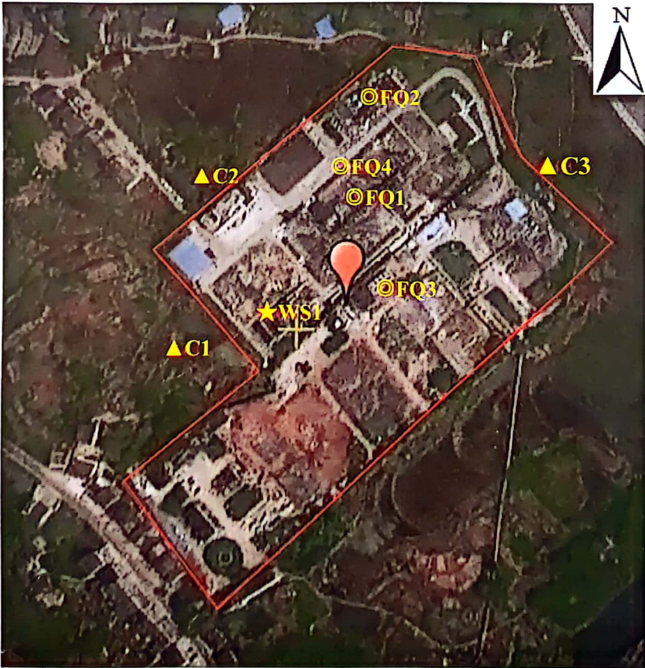
图 1 废水、有组织废气和厂界噪声监测布点示意图
